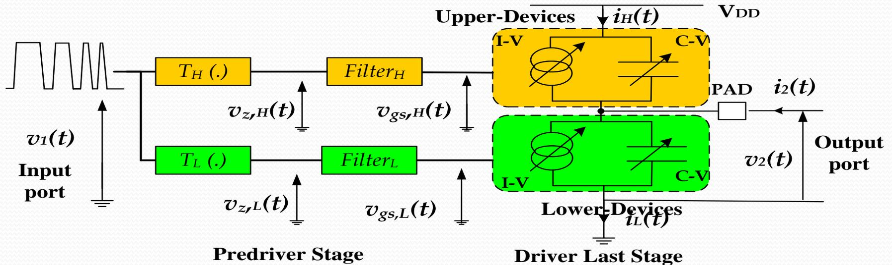
$$\begin{cases} v_{z,j}(t) = T_j(v_1(t)) \\ v_{g,j}(t) = \int_0^t h_j(\rho) v_{z,j}(t - \rho) d\rho \end{cases} ; j = L, H$$
